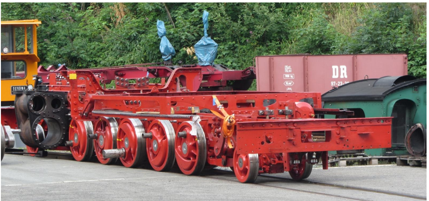
Kuvassa on veturityypin aluskehys huollettuna 29.7.2019, kuva Timo Heiskari Tenderi 1/2020
