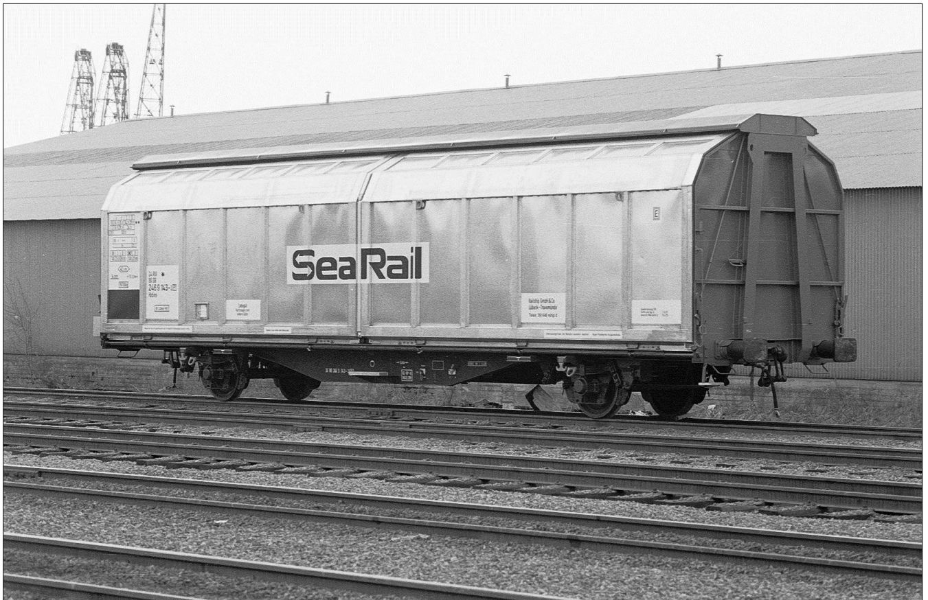
SeaRail Hbbins 24 80 246 9 103-7 [P], Turku 1989 (ylh.) ja 24 80 246 9 143-3 [P], Turku Linnanaukko (alh.) Huom. päädyn toisenlainen pystytukirakenne, puuttuvat käsipyörät ja ”kalanvatsa-alusta”. Kuvat: Olli Savela
