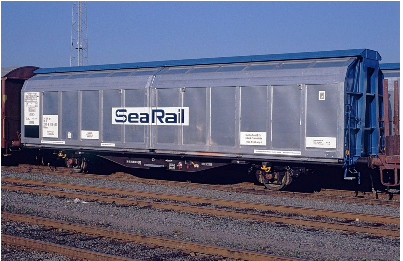
SeaRail Hbbins 24 80 246 9 103-7 [P], Turku 1989 (ylh.) ja 24 80 246 9 143-3 [P], Turku Linnanaukko (alh.) Huom. päädyn toisenlainen pystytukirakenne, puuttuvat käsipyörät ja ”kalanvatsa-alusta”. Kuvat: Olli Savela
