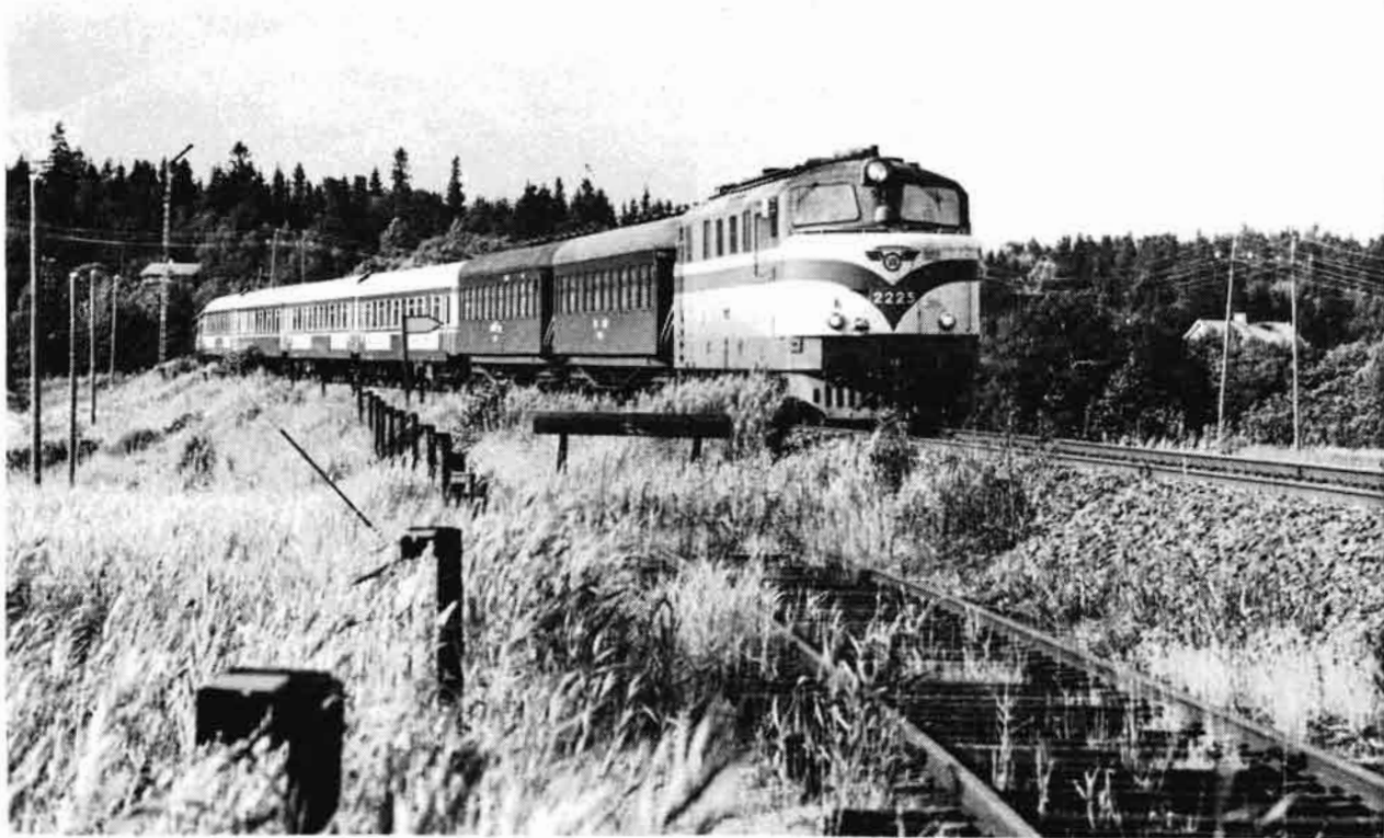
Dr12 n:o 2225:n vetämä pikajuna n:o 104 saapumassa Turkuun ns. Hellaksen vaihteen kohdalla. Junassa on kaksi vanhaa Ei-tyypin puuvaunua ja viisi uutta teräsrunkoista matkustajavaunua. Kuva on otettu heinäkuun 18. päivänä 1981 noin klo 18.20. Kuva: Esko Maasalo.
