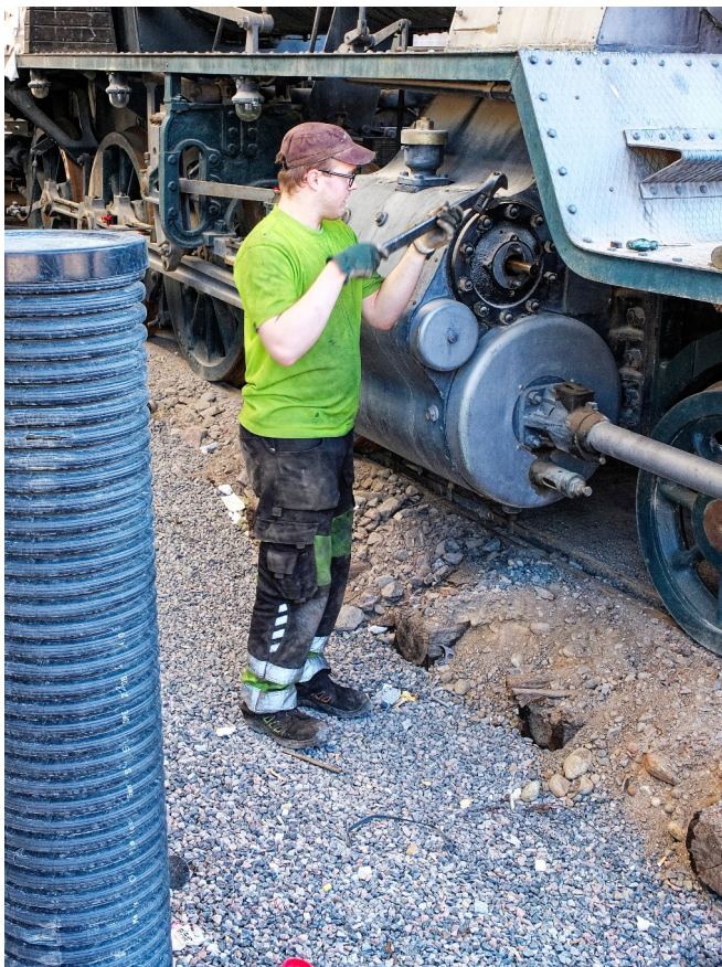
Robin Raita luistikaapin kannen muttereita löysäämässä. 13.5.2023
