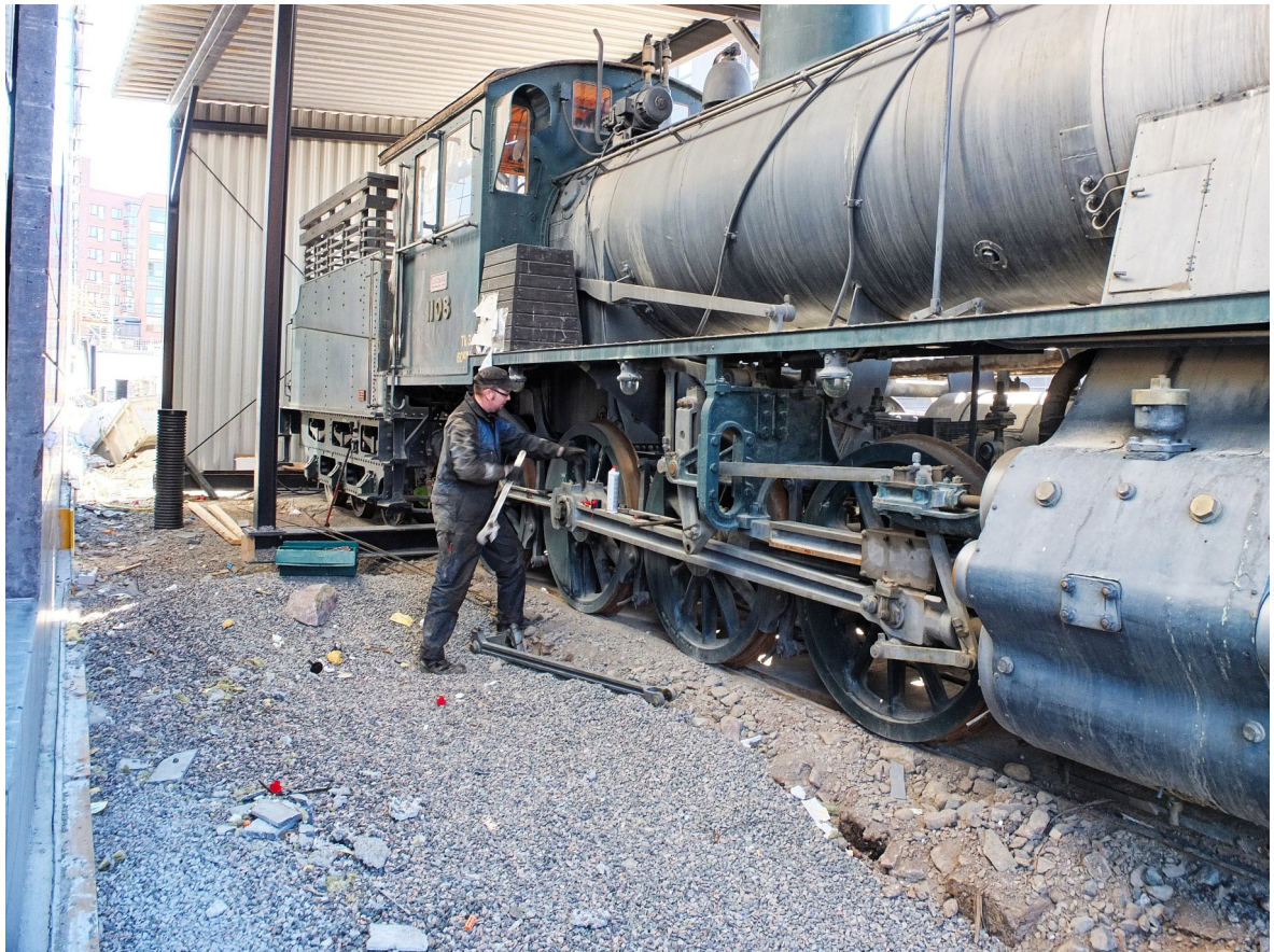
Lasse Tauriainen on saanut epäkeskotangon irroitetuksi. 13.5.2023
